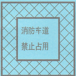
消防车通道出入口禁停标线及路面警示标志
