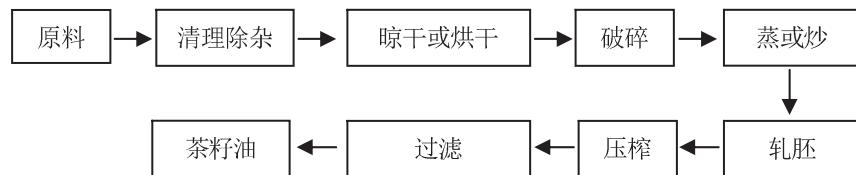
图1 茶籽油工艺流程
